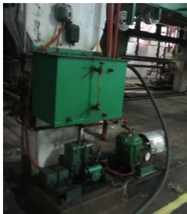
Систем за подмачкување на машината за производство на хартија
